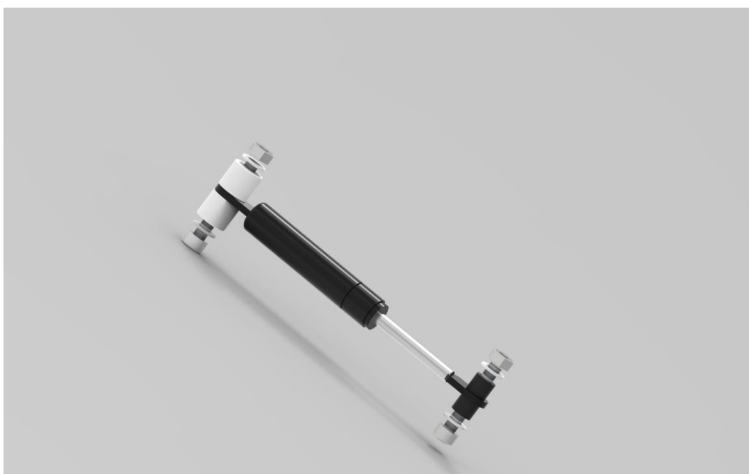
Rysunek 3 Zamontuj damper z pomocą dwóch śrub na górze M6x30 i M6x40 poniżej.
